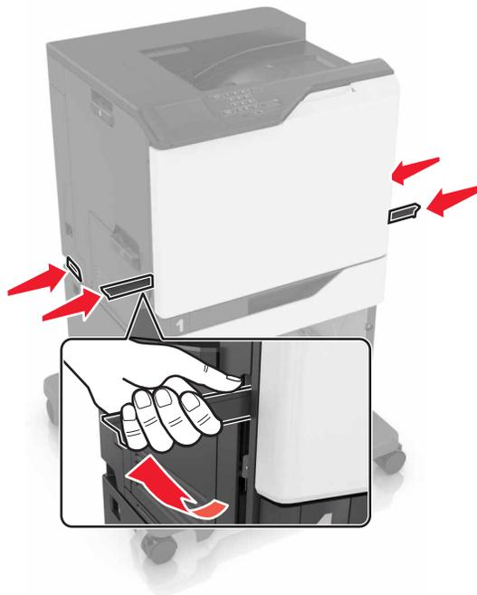
**Remarque :** Si des tiroirs optionnels sont déjà installés, déverrouillez-les sur l'imprimante avant de la soulever. N'essayez pas de soulever l'imprimante et les tiroirs en même temps.
