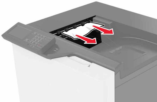
**2** Åpne deksel B, og fjern fastkjørte papirdeler.
