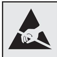
Ta oznaka označuje dele, občutljive na statično elektriko. Preden se dotaknete delov v bližini teh oznak, se najprej dotaknite kovinske površine, ki se ne nahaja v bližini oznake.
