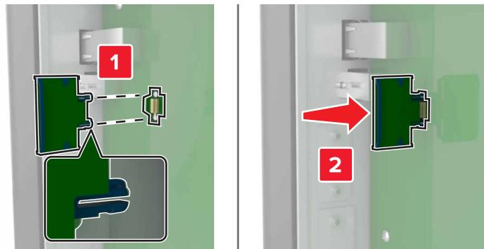
**Opomba:** Celotna dolžina priključka kartice se mora dotikati nadzorne plošče in biti z njo poravnana.
