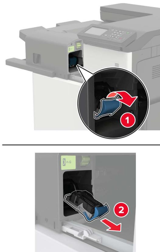
**3** Entfernen Sie die losen Heftklammern.
