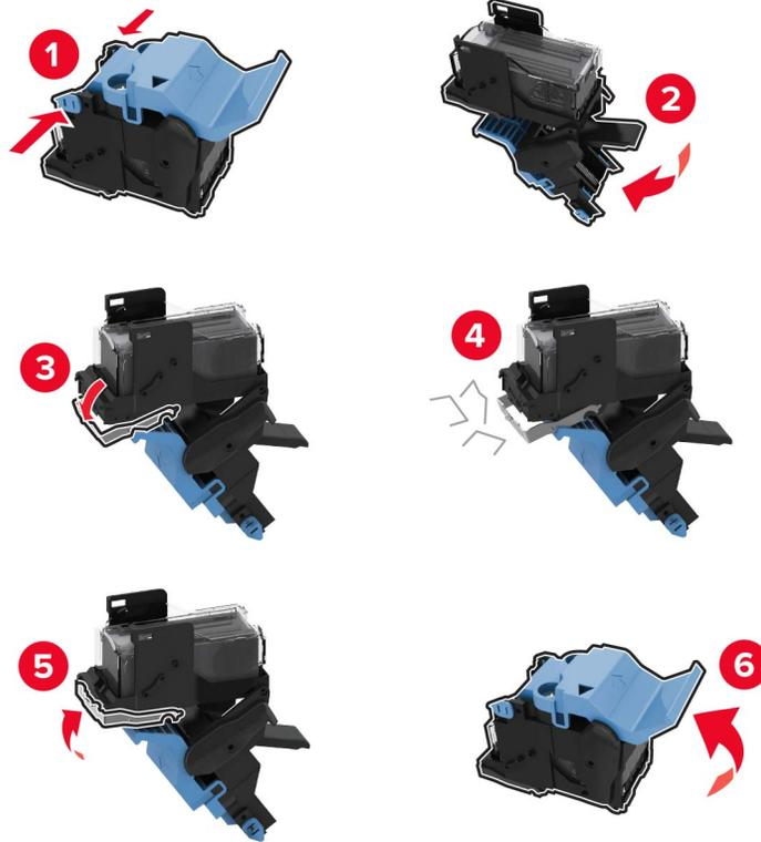
**4** Einsetzen der Halterung der Heftklammerkassette, bis sie hörbar *einrastet*.
