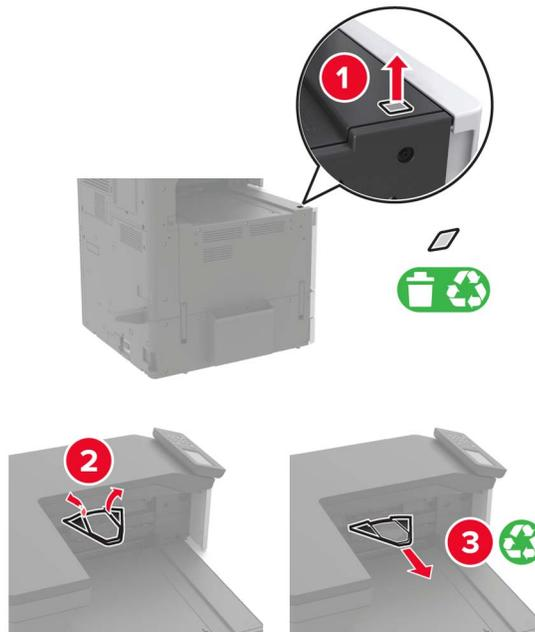
**6** Entfernen Sie den Papierführungssensorabdeckungen mithilfe des Schraubendrehers in Klappe A und die Führungsschienenabdeckungen.
