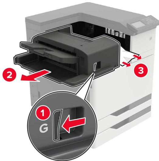
Drehen Sie bei Bedarf das Spinnrad G1 nach unten, um gestautes Papier in die Finisher-Ablage zu leiten, und entfernen Sie dann das gestaute Papier.
