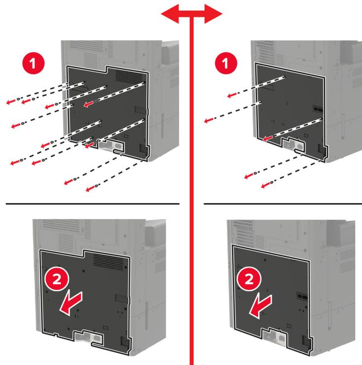
**6** Entfernen Sie die Controller-Platinenabdeckung.
