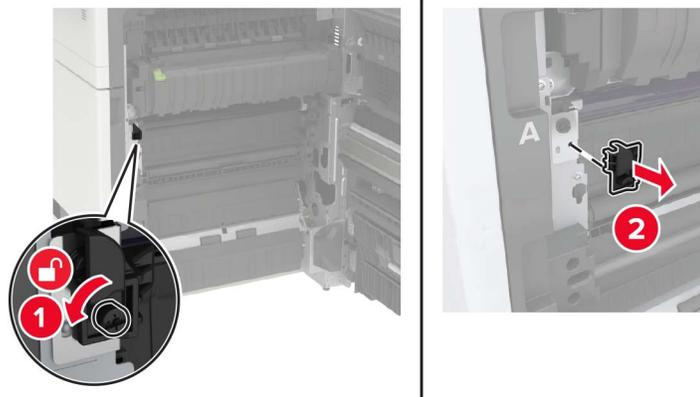
**4** Lösen Sie die Schrauben, die das Übertragungsband sichern.
