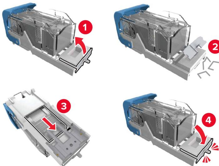
**4** Einsetzen der Halterung der Heftklammerkassette, bis sie hörbar *einrastet*.
