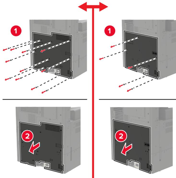
6 Entfernen Sie die Controller-Platinenabdeckung.
