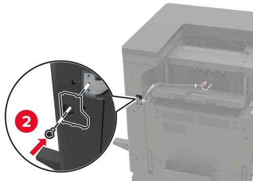
**11** Bringen Sie die Abdeckung der Führungsschiene des Finishers an.
