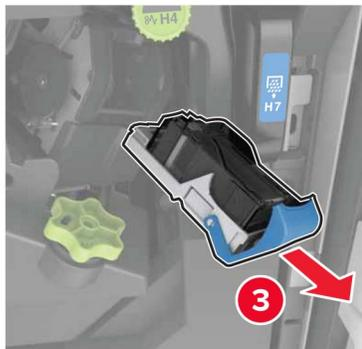
**3** Entfernen Sie die losen Heftklammern.
