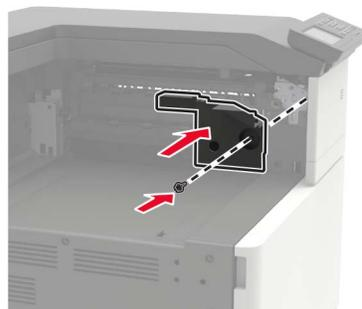
**9** Setzen Sie den Finisher ein.
