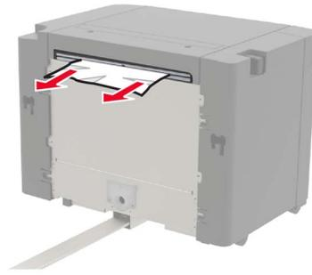
**3** Öffnen Sie Klappe F und entfernen Sie das gestaute Papier.
