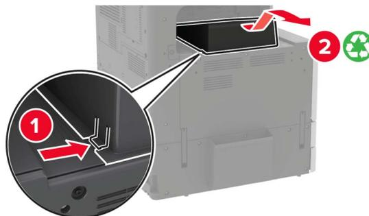
**5** Entfernen Sie die Klebefolie, und entfernen Sie dann den Papierballen.
