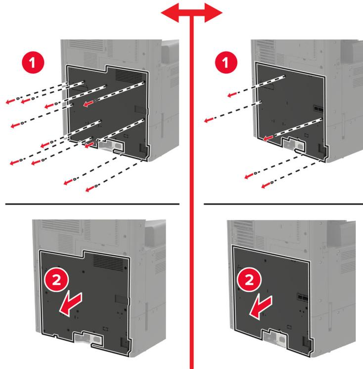
**6** Entfernen Sie die Controller-Platinenabdeckung.
