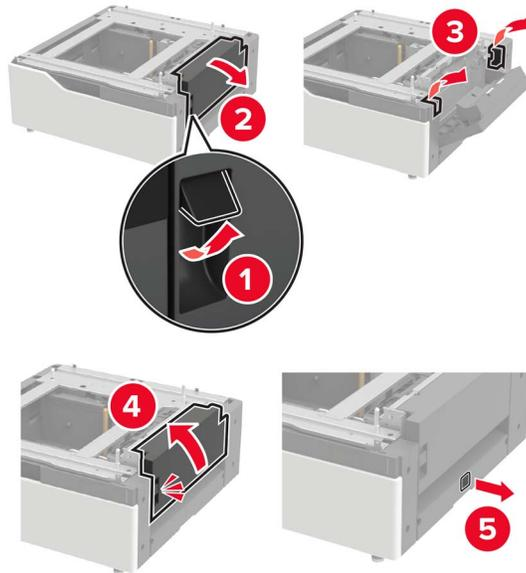
**11** Öffnen Sie das Fach, und entfernen Sie dann die Halterung und Führungsschienen.
