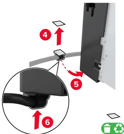
**18** Schließen Sie das Fachkabel an den Drucker an.
