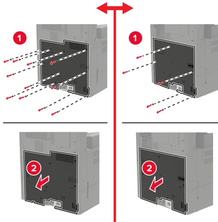
4 Entfernen Sie die Controller-Platinenabdeckung.
