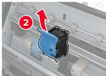
**3** Entfernen Sie die losen Heftklammern.
