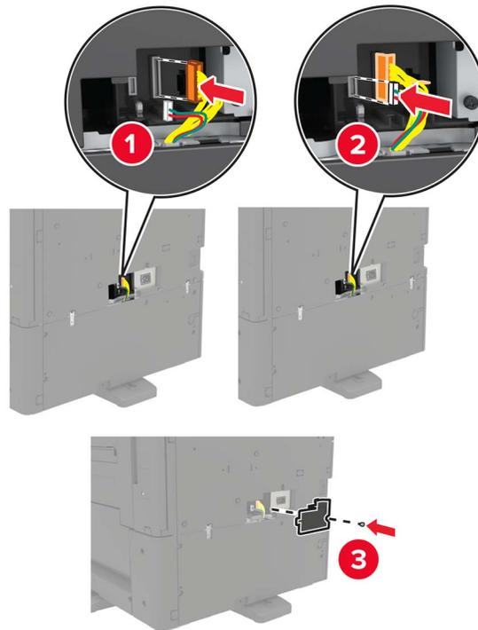
**23** Öffnen Sie die Fächer 2 und 3, und sichern Sie das 2 x 500- oder 2500-Blatt-Fach mit den Befestigungsklammern und der Metallhalterung.
