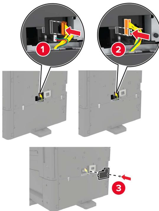
**23** Aprire i vassoi 2 e 3, quindi fissare il vassoio da 2 x 500 o 2500 fogli alla stampante con i morsetti di fissaggio e la staffa di metallo.
