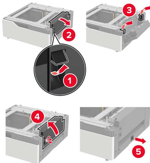
**11** Aprire il vassoio, quindi rimuovere la staffa di montaggio e le coperture delle guide.
