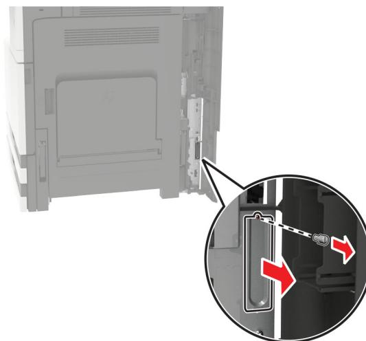
**7** Despachetați serverul de imprimare fără fir, apoi treceți-l prin slotul pentru opțiuni.
