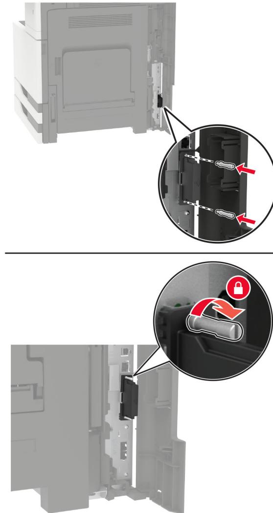
**9** Conectați serverul de imprimare fără fir la placa controlerului.
