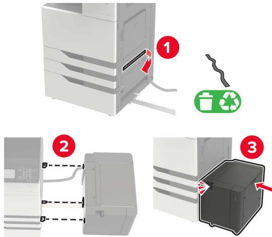
**21** Montați picioarele de stabilizare la imprimantă.
