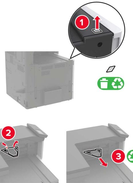
**6** Utilizând șurubelnita depozitată în ușa A, scoateți capacele pentru senzorul ghidajului hârtiei și șinele glisante.
