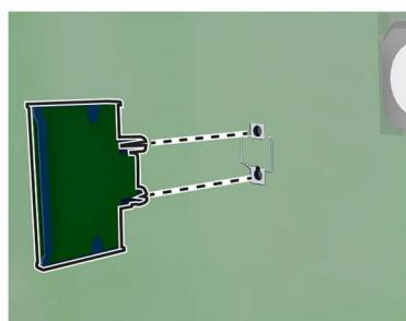
**Notă:** Întreaga lungime a conectorului cardului trebuie să atingă și să fie la același nivel cu placa de sistem.
