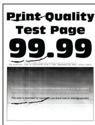
**Примечание:** Прежде чем приступить к решению проблемы, распечатайте страницы с примерами получаемого качества, чтобы определить причину появления повторяющихся дефектов. На начальном экране коснитесь **Параметры > Поиск и устранение неисправностей > Страницы проверки качества печати.**
