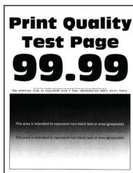
**Примечание:** Прежде чем приступить к решению проблемы, напечатайте страницы с примерами получаемого качества, чтобы определить отсутствующий цвет. На начальном экране коснитесь **Параметры > Поиск и устранение неисправностей > Страницы проверки качества печати**.
