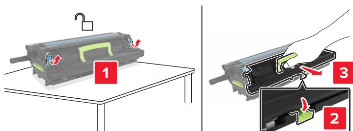
**5** Otpakirajte novu jedinicu za razvijanje, a zatim uklonite materijal pakiranja.
