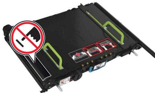
7 新しい転写ベルトを、所定の位置でカチッという音がするまで挿入します。
