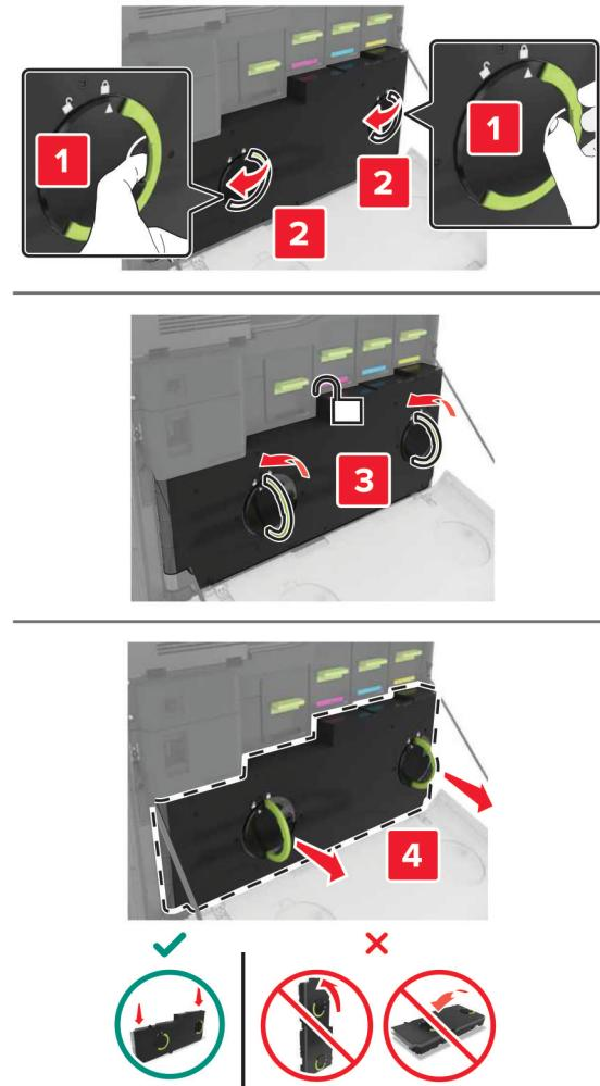
**3 移除成像部件。**
