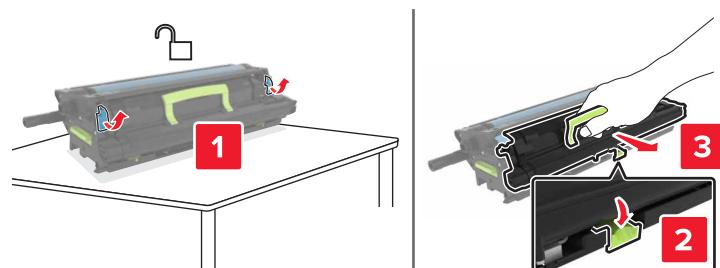
5 拆开新的显影部件的包装，然后移除包装材料。
