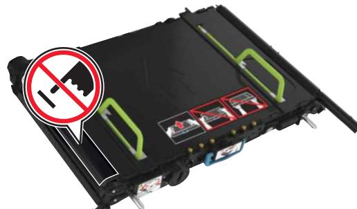
**7** Vložte nový prenosový pás tak, aby *s kliknutím* zapadol na miesto.
