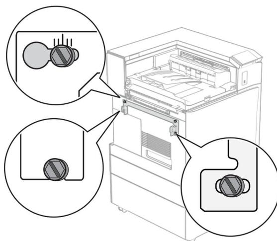
31 用紙搬送ユニットに付属の金属のブラケットをプリンタに取り付けます。
