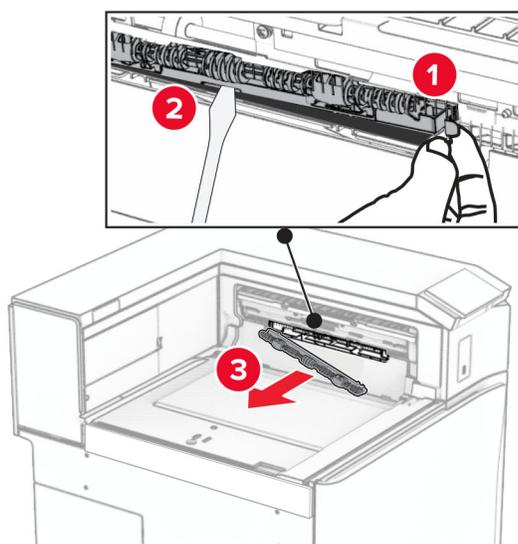
8 ホチキスフィニッシャに付属しているフィードローラーを挿入し、カチッと音がすることを確認します。
