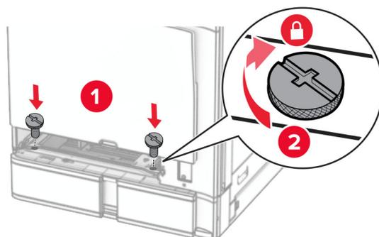
16 標準トレイの引き出し部を挿入します。
