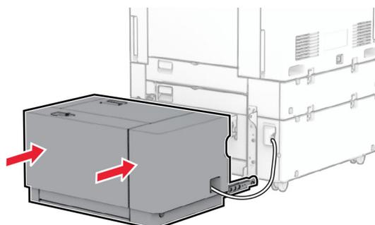
14 プリンタの電源コードの一方の端をプリンタに接続してから、もう一方の端をコンセントに差し込みます。
