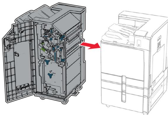
35 フィニッシャをプリンタに固定し、ネジを取り付けます。
