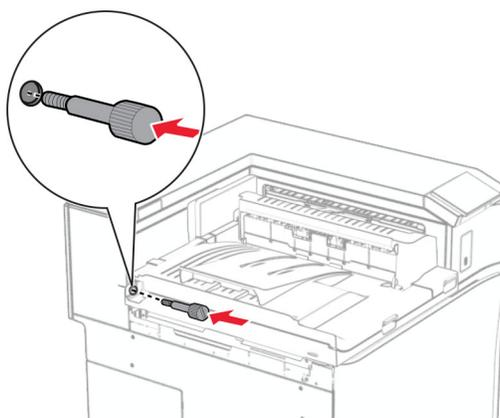
18 前面ドアを開け、用紙搬送ユニットに付属のカバーをプリンタの左側に取り付けます。
