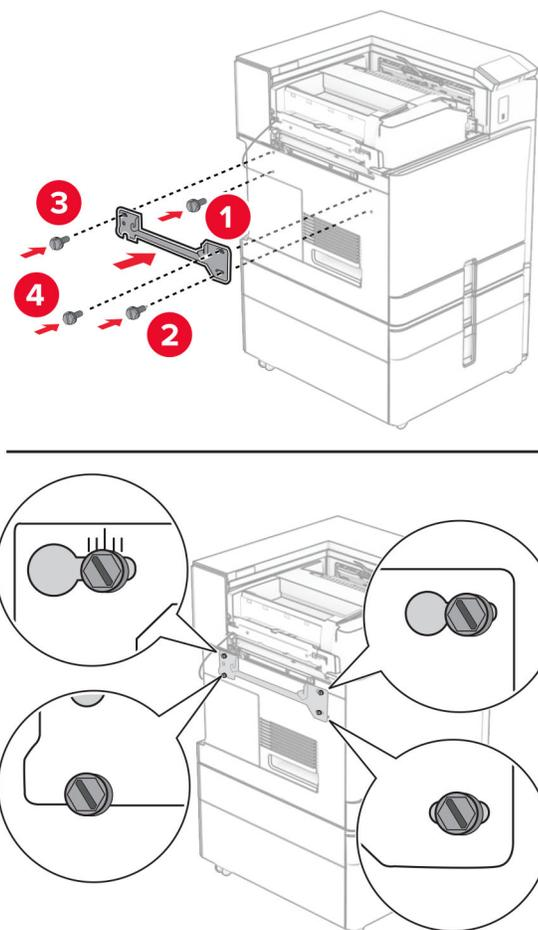
40 フィニッシャのドアを開け、ネジを外し、フィニッシャのロックを引き出します。
