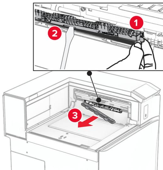
7 オプションに付属しているフィードローラーを挿入し、カチッと音がすることを確認します。
