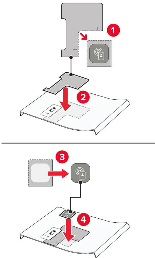
9 前面の USB ポートカバーを取り付け、カチッと音がすることを確認します。
