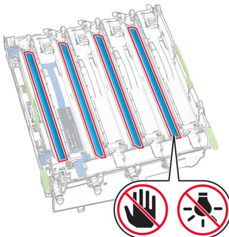
**メモ:** フォトコンダクタードラムに傷や損傷を与えないように、イメージングキットを清潔で平らな場所に、垂直に置きます。
