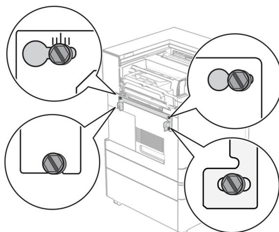
39 フィニツシャのドアを開け、ネジを外し、フィニツシャのロックを引き出します。
