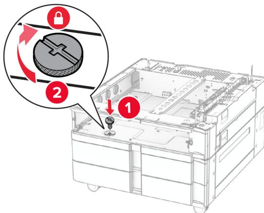
8 550 枚トレイの引き出し部を挿入します。
