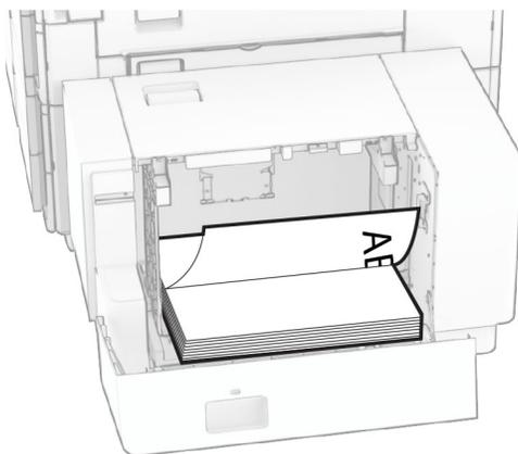
両面印刷の場合、レターヘッド紙は、ヘッダーがプリンタの後方を向くように上向きにセットします。
