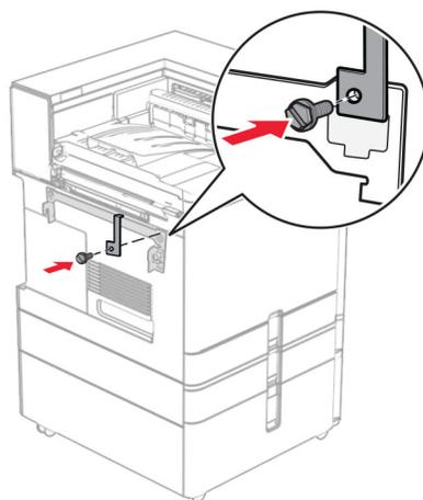
**32** フィニッシャのドアを開け、ネジを外し、フィニッシャのロックを引き出します。
