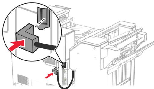
36 電源コードの一方の端をプリンタに接続してから、もう一方の端をコンセントに差し込みます。
