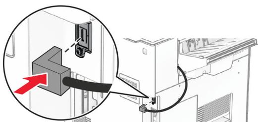
23 プリンタの電源コードの一方の端をプリンタに接続してから、もう一方の端をコンセントに差し込みます。
