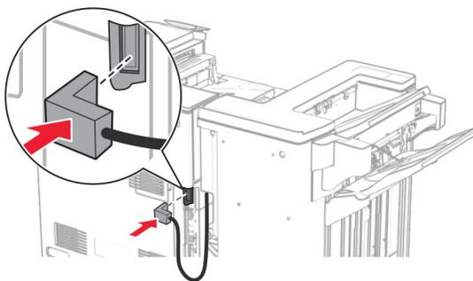
38 電源コードの一方の端をプリンタに接続してから、もう一方の端をコンセントに差し込みます。
