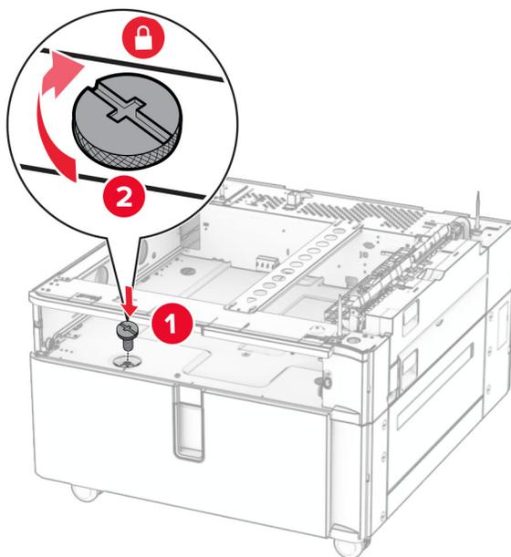
8 トレイの引き出し部を挿入します。
