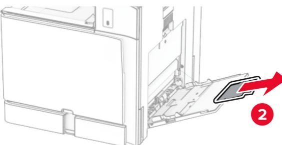
2 セットする用紙のサイズに合わせて側面ガイドを調整します。
