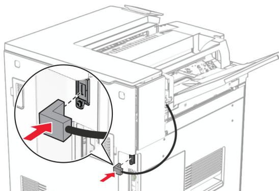
31 電源コードの一方の端をプリンタに接続してから、もう一方の端をコンセントに差し込みます。
