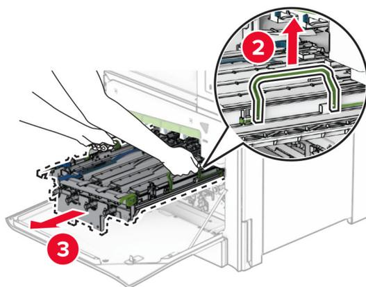
メモ: フォトコンダクタードラムに傷や損傷を与えないように、イメージングキットを清潔で平らな場所に、垂直に置きます。
