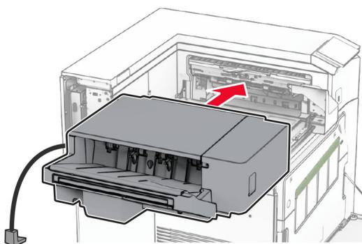
17 取り付けブラケットを取り付けて、フィニッシャをプリンタに固定します。
