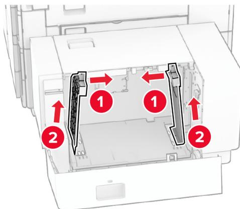
3 セットする用紙のサイズに合わせて用紙ガイドを調整します。
