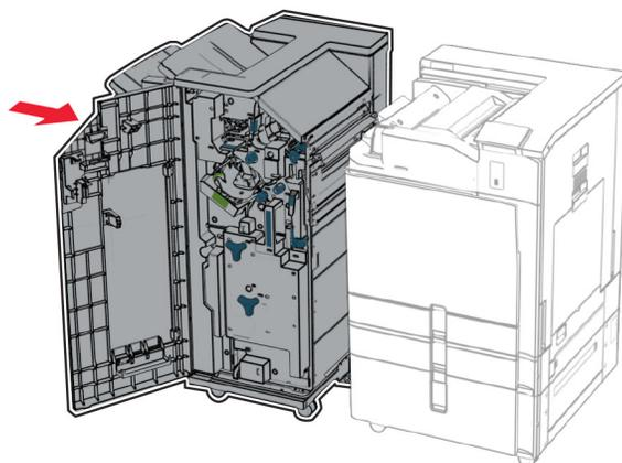
44 フィニッシャをプリンタに固定し、ネジを取り付けます。
