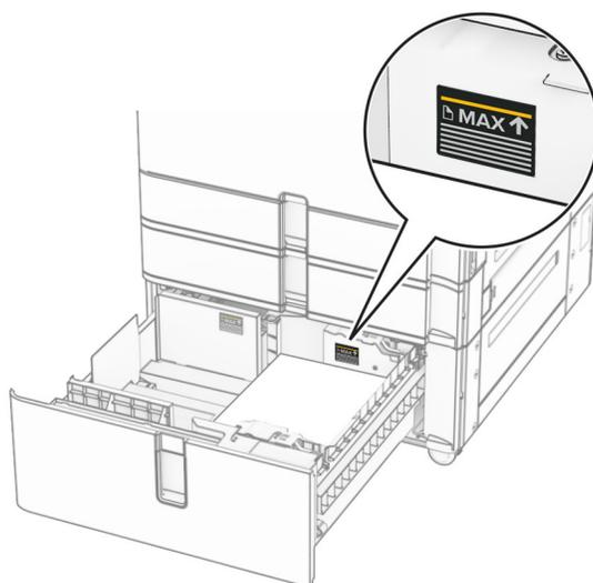
4 プリンタに右トレイの引き出し部を挿入します。
