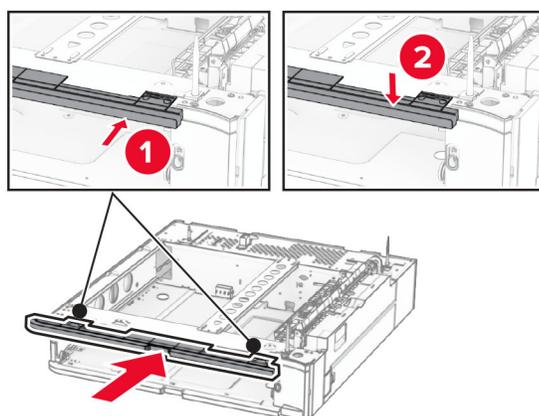
11 550 枚トレイの引き出し部を挿入します。
