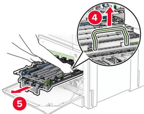
**警告—破損の恐れあり:** イメージングキットを直射日光にさらさないでください。長時間直射日光にさらすと、印刷品質の問題が生じる可能性があります。
