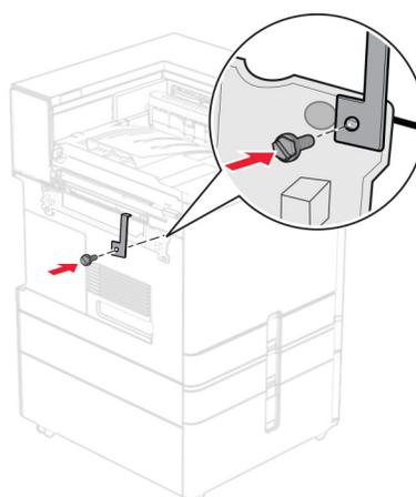
33 フィニッシャのドアを開け、ネジを外し、フィニッシャのロックを引き出します。
