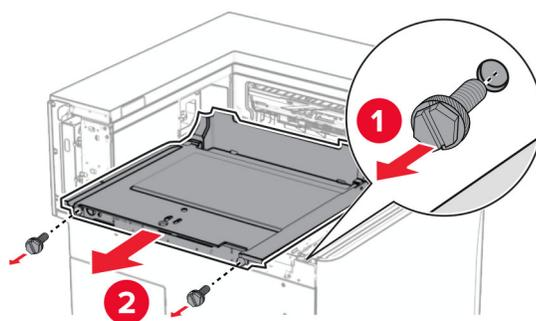
14 位置を合わせてから、折り畳みオプション付き用紙搬送ユニットに付属する内部排紙トレイカバーを挿入します。
