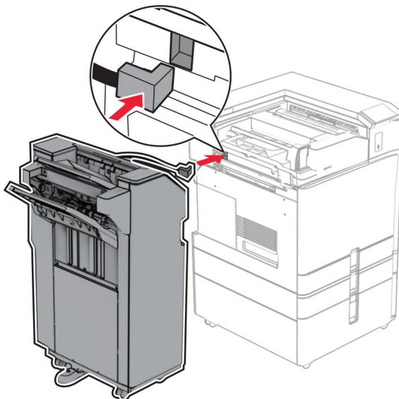
43 フィニッシャをプリンタに固定し、ネジを取り付けます。
