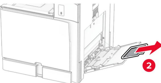
2 调整侧导片以匹配加载的纸张尺寸。
