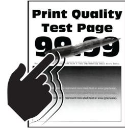
**ملاحظة:** قبل حل المشكلة، اطبع صفحات اختبار جودة الطباعة. من لوحة التحكم، انتقل إلى الإعدادات > استكشاف الأخطاء وإصلاحها > صفحات اختبار جودة الطباعة. عند استخدام طرازات الطباعة غير المزودة بشاشة لمس، اضغط على **OK** للانتقل عبر الإعدادات.
