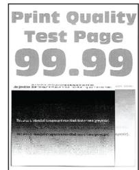
**ملاحظة:** قبل حل المشكلة، اطبع صفحات اختبار جودة الطباعة. من لوحة التحكم، انتقل إلى الإعدادات < استكشاف الأخطاء وإصلاحها < صفحات اختبار جودة الطباعة. عند استخدام طرازات الطباعة غير المزودة بشاشة لمس، اضغط على **OK** للتنقل عبر الإعدادات.
