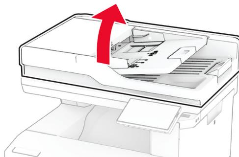
2 Remova a almofada do vidro do scanner usada.
