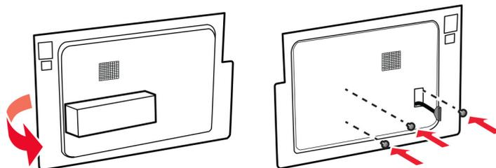
**8** Conecte o cabo da interface do disco rígido à placa do controlador.
