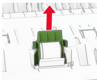
**4** Aplique álcool isopropílico em um pano macio e sem fiapos e limpe o rolo de transporte e o rolo de separação do ADF.
