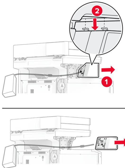
**6** Remova a fonte de energia usada.
