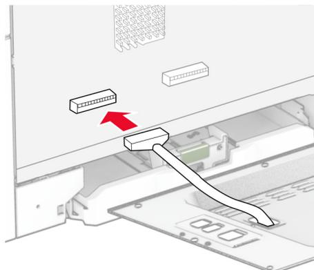
**9** Conecte o cabo da interface do fax à placa do controlador.
