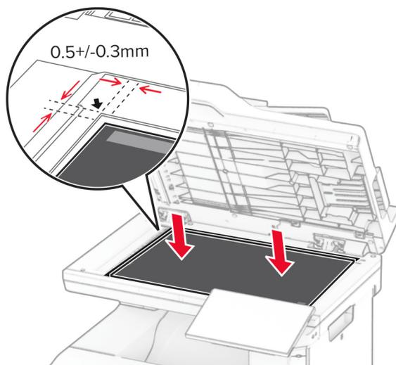
**5** Feche a tampa do scanner para fixar a nova almofada do vidro do scanner.
