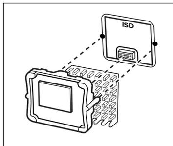
7 Fixe a proteção da placa do controlador e, em seguida, instale os parafusos.
