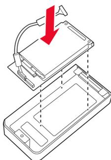
**7** Fixe o disco rígido na proteção da placa do controlador.
