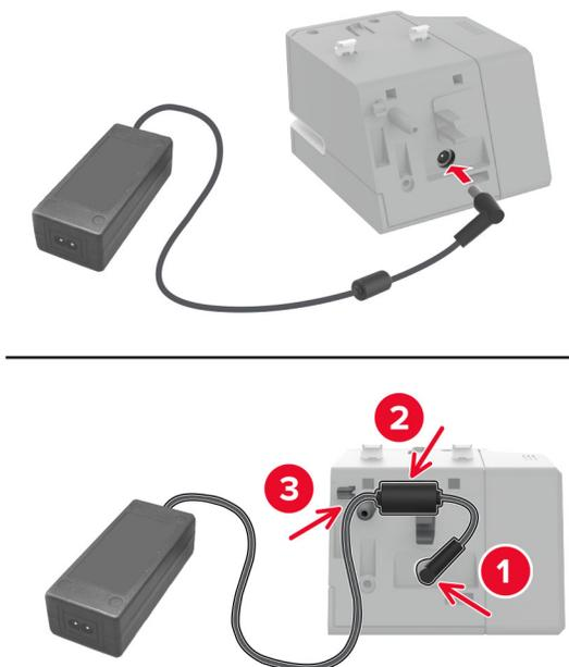
**Nota:** Utilizzare solo l'alimentatore fornito con la cucitrice di base. L'utilizzo di qualsiasi altro alimentatore può danneggiare il prodotto.
