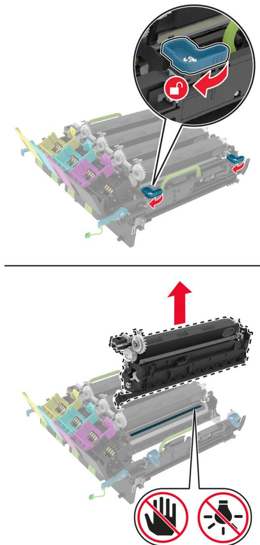
**Attenzione - Possibili danni:** Non esporre l'unità fotoconduttore alla luce diretta per più di 10 minuti. L'eccessiva esposizione alla luce può compromettere la qualità di stampa.
