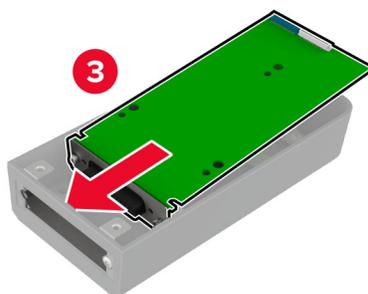
**5** Fissare l'alloggiamento alla schermatura della scheda del controller.
