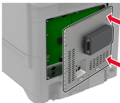
**7** Fissare la schermatura della scheda del controller.
