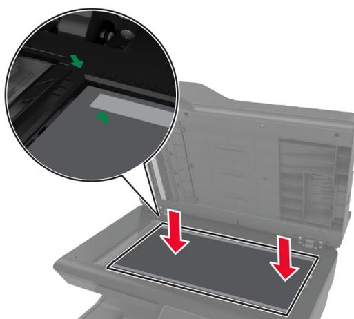
**Nota:** Assicurarsi che il pannello di vetro dello scanner sia allineato correttamente sui bordi del vetro dello scanner.
