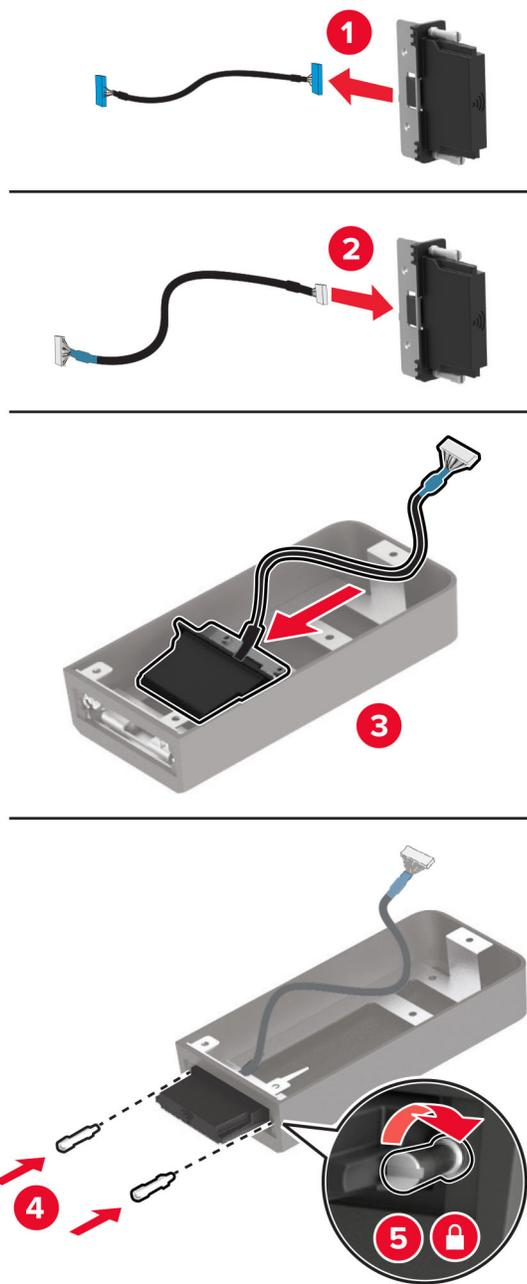
**4** Fissare il modulo wireless alla schermatura della scheda del controller.
