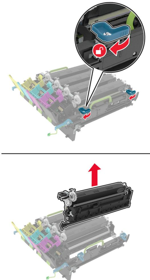
**Attenzione - Possibili danni:** Non esporre l'unità fotoconduttore alla luce diretta per più di 10 minuti. L'eccessiva esposizione alla luce può compromettere la qualità di stampa.
