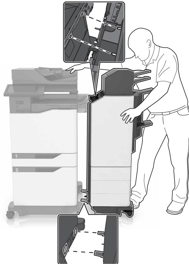
**14** Zasuňte dokončovací jednotku do tiskárny zatlačením na dno tiskárny, až zaklapne na místo.
