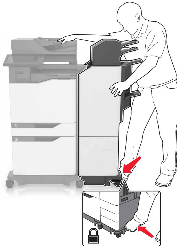
Zkontrolujte, zda jsou dokončovací jednotka a tiskárna správně zajištěny: vytáhněte dokončovací jednotku silou z tiskárny. Pokud se dokončovací jednotka od tiskárny oddělí, opakujte postup ([krok 13](#) až [krok 14](#)), dokud nebudou zařízení správně zajištěna.
