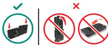
**3** Entfernen Sie die Belichtungseinheit.
