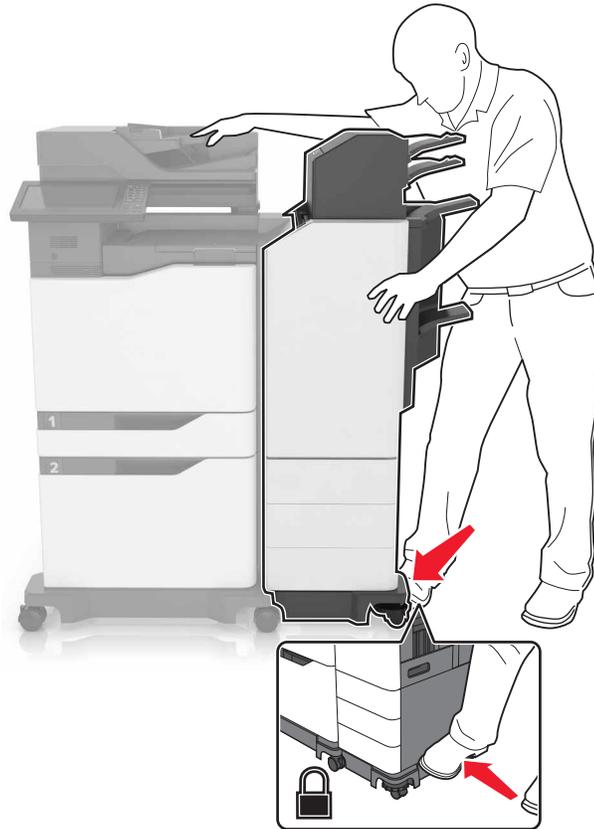
Überprüfen Sie, ob der Finisher und der Drucker richtig miteinander verbunden sind, indem Sie den Finisher vom Drucker wegziehen. Wenn sich der Finisher vom Drucker löst, wiederholen Sie [Schritt 13](#) bis [Schritt 14](#), bis sie richtig miteinander verbunden sind.
