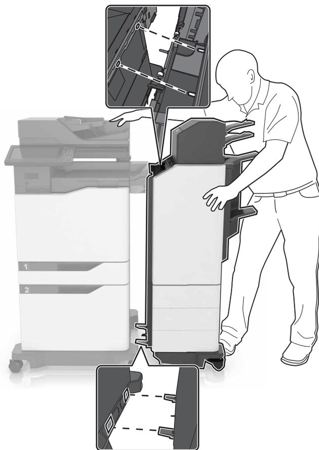
**14** Schieben Sie den Finisher mit Druck von unten an den Drucker, bis er *hörbar einrastet*.
