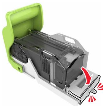
6 Setzen Sie die Halterung der Heftklammerkassette ein.
