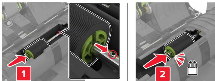
**7** Introduceți capacul rolei de separare a unității ADF până când aceasta se fixează cu un *clic* în poziție.
