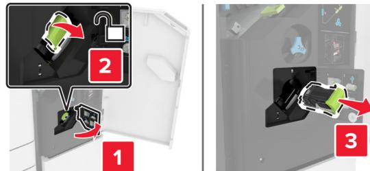
**3** Deschideți garda capsatorului și scoateți capsele slăbite.
