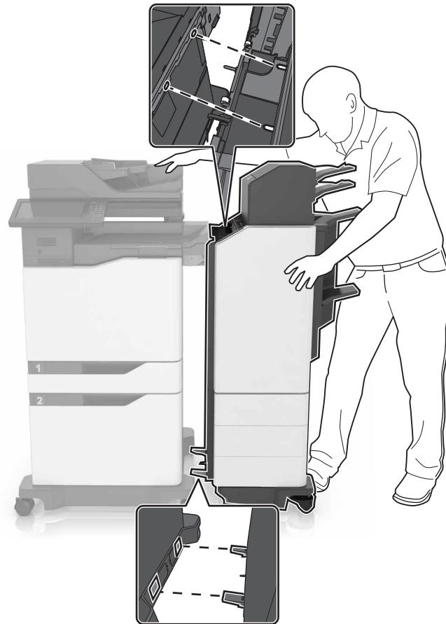
**14** Împingeți finisorul în imprimantă prin aplicarea de presiune la baza acestuia până când se va fixa cu un *clic* în poziție.
