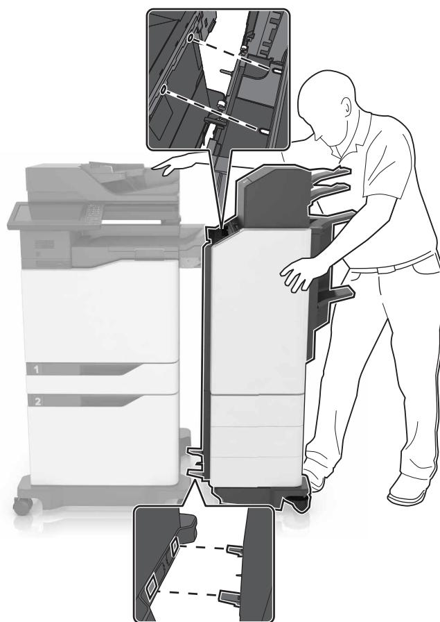
**14** Придвиньте брошюровщик к принтеру, нажимая на нижнюю часть брошюровщика до **зашелкивания** на месте.
