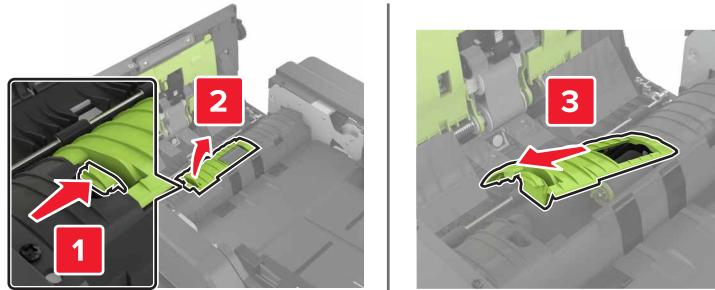
4 Снимите ролик разделения УАПД.
