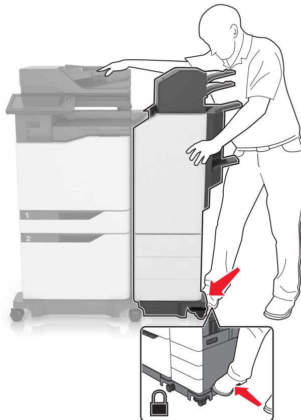
Проверьте надежность крепления брошюровщика с принтером, с усилием потянув брошюровщик в сторону от принтера. Если брошюровщик отделяется от принтера, повторите [шаг 13](#) процедуру [шаг 14](#), пока надежное крепление не будет достигнуто.
