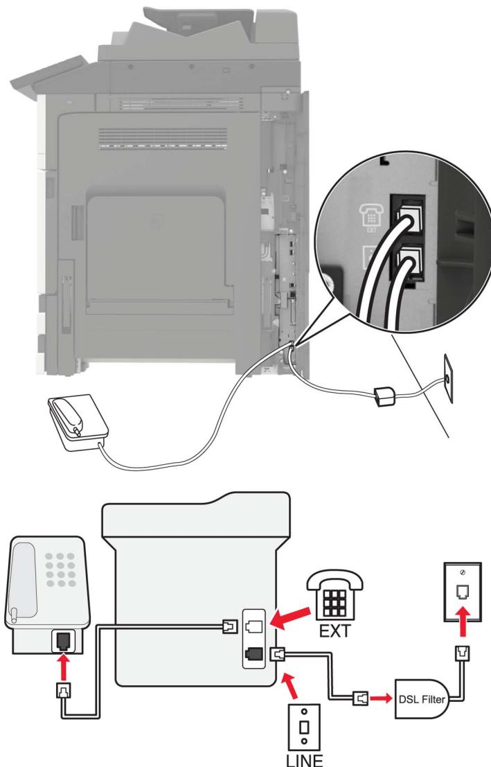
O linie digitală de abonat (digital subscriber line - DSL) împarte linia dvs. telefonică obișnuită în două canale: voce și Internet. Semnalele de telefon și de fax circulă prin canalul de voce, iar semnalele de Internet trec pe celălalt canal.
