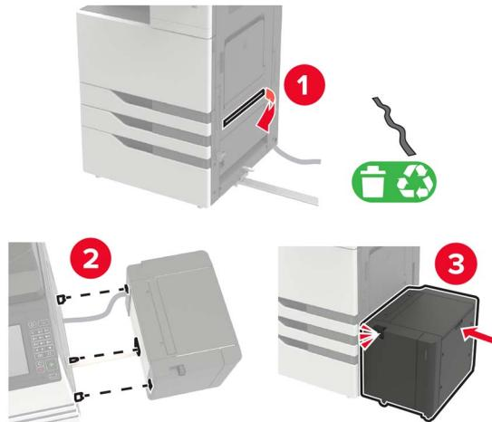
**21** Montați picioarele de stabilizare la imprimantă.
