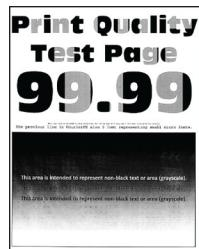
**Notă:** Înainte de soluționarea problemei, imprimați paginile de testare a calității imprimării. Din panoul de control, accesați **Setări > Depanare > Pagini de testare a calității imprimării**. Pentru modelele de imprimantă care nu dispun de ecran tactil, apăsați **OK** pentru a naviga printre setări.
