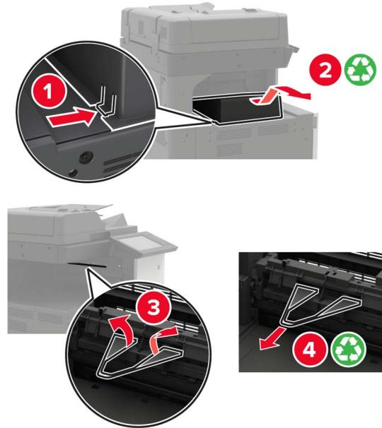
6 Cu o șurubelnă depozitată în ușa A, îndepărtați ghidajele pentru hârtie.
