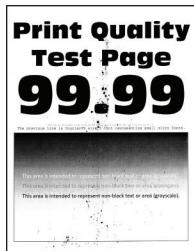
**Notă:** Înainte de soluționarea problemei, imprimăți paginile de testare a calității imprimării. Din panoul de control, accesați **Setări > Depanare > Pagini de testare a calității imprimării**. Pentru modelele de imprimantă care nu dispun de ecran tactil, apăsați **OK** pentru a naviga printre setări.
