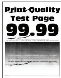
**Notă:** Înainte de soluționarea problemei, imprimați paginile de testare a calității imprimării. Din panoul de control, accesați **Setări > Depanare > Pagini de testare a calității imprimării**. Pentru modelele de imprimantă care nu dispun de ecran tactil, apăsați **OK** pentru a naviga printre setări.
