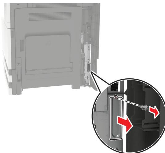
**7** Despachetați serverul de imprimare fără fir, apoi treceti-l prin slotul pentru opțiuni.
