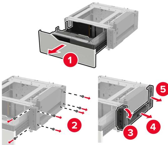
**12** Atașați suporturile de montare laterale în tavă, apoi introduceți placa de ghidare în şină.
