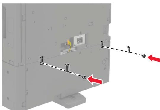
**10** Închideți tăvile, apoi montați la loc capacul conectorului.
