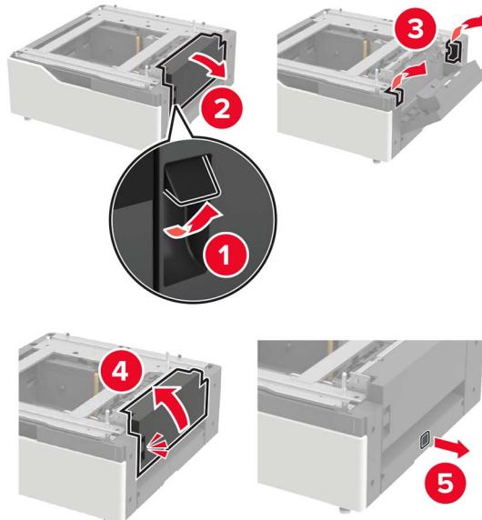
**11** Откройте лоток, затем снимите крепежный кронштейн и крышки направляющей.
