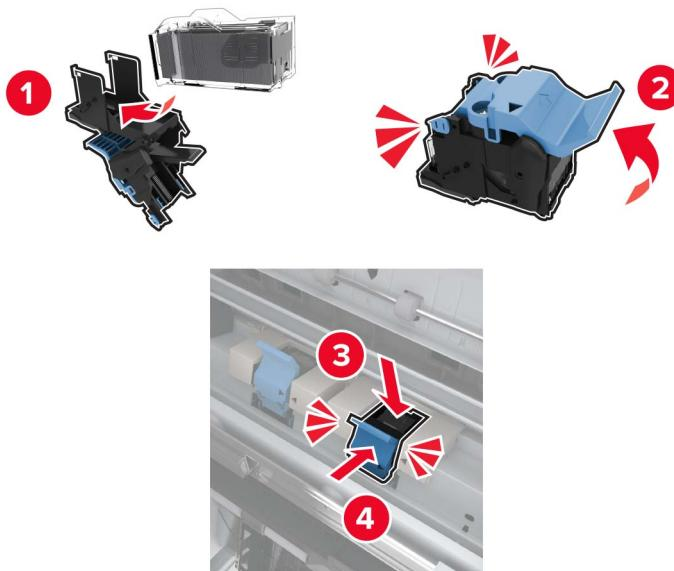
5 Задвиньте брошюровщик на место, затем закройте дверцу.
