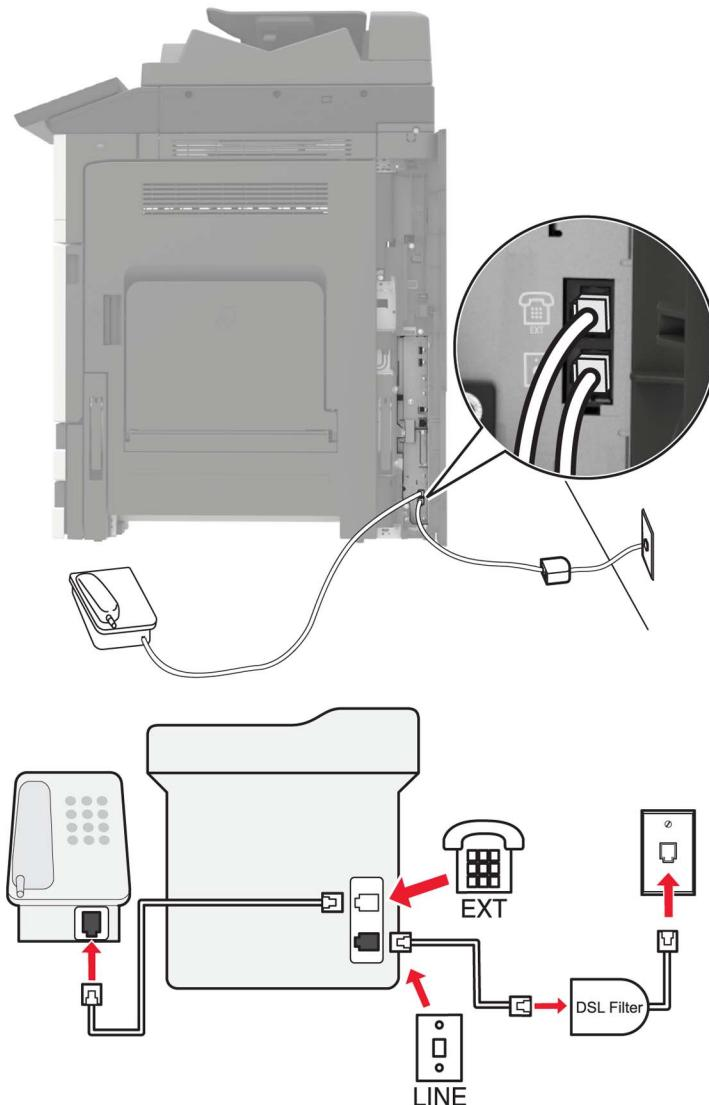
Линия DSL разделяет обычную телефонную линию на два канала: голосовой и Интернет. Сигналы телефона и факса передаются по голосовому каналу, а сигналы Интернета – по другому.
