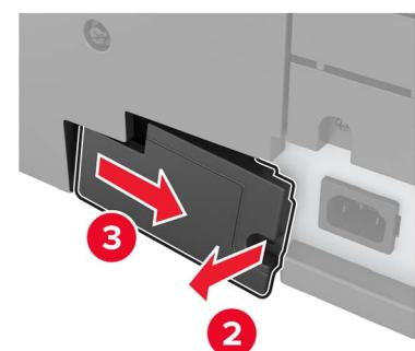
4 Если принтер оснащен крышкой фильтра, снимите ее.
