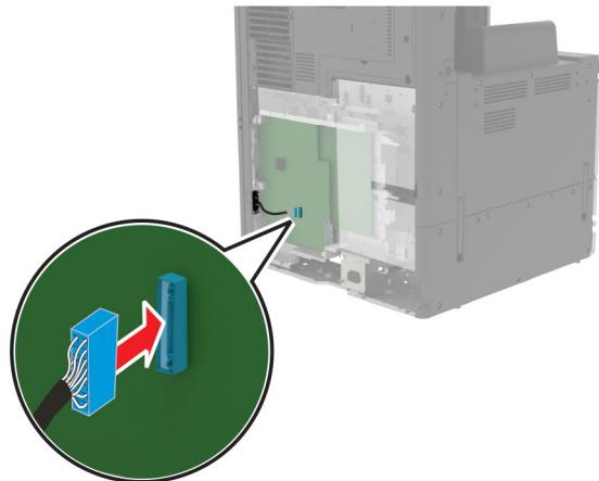
**10** Установите на место щиток, затем установите на место крышку доступа.
