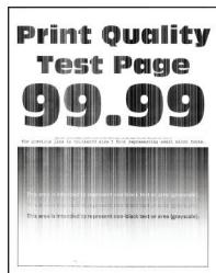
**Примечание:** Перед решением проблемы распечатайте страницы проверки качества печати. На панели управления перейдите к **Параметры > Устранение проблем > Страницы проверки**
