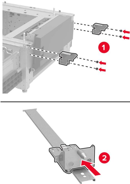
**13** Закрепите направляющую, затем закрепите крепежный кронштейн и крышки направляющей.
