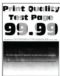
**Примечание:** Перед решением проблемы распечатайте страницы проверки качества печати. На панели управления перейдите к **Параметры > Устранение проблем > Страницы проверки качества печати**.
