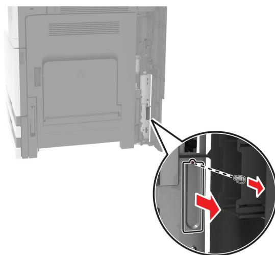
**7** Распакуйте сервер беспроводной печати и продвиньте его через разъем для дополнительного оборудования.
