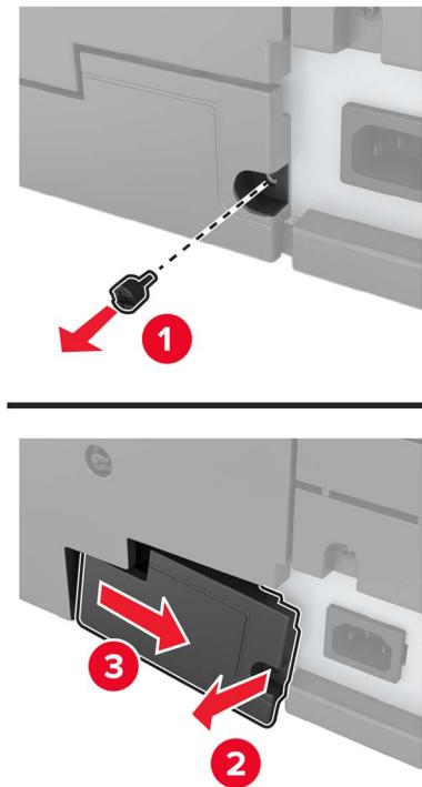
**4** Если принтер оснащен крышкой фильтра, снимите ее.
