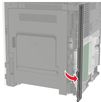
**6** Снимите крышку разъема для дополнительного оборудования.
