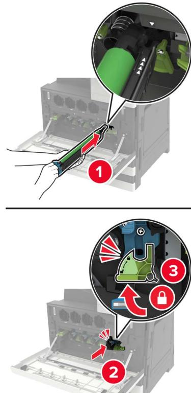
**6** Скребком пчатающей головки очистите линзу пчатающей головки.
