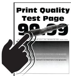
**Примечание:** Перед решением проблемы распечатайте страницы проверки качества печати. На панели управления перейдите к **Параметры > Устранение проблем > Страницы проверки**
