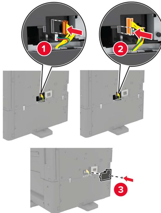
**23** Откройте лотки 2 и 3, затем закрепите лотки на 2 x 500 или 2500 листов на принтере зажимами и металлической скобой.
