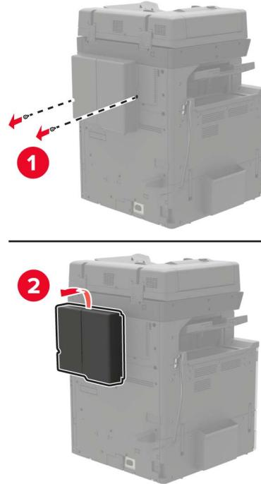
5 Снимите защитную крышку системной платы.
