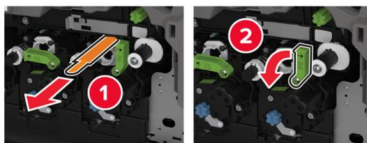
**9** Remova o limpador do cabeçote de impressão e limpe as lentes do cabeçote de impressão.
