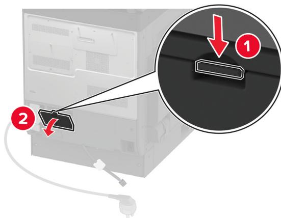
**9** Ligue o conector da bandeja à impressora e, em seguida, encaixe a tampa.
