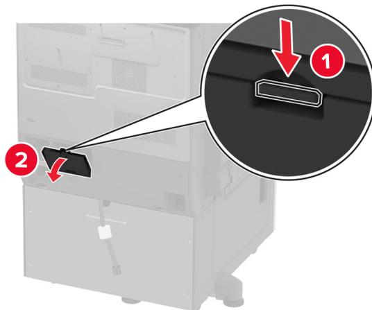
**10** Ligue o conector da bandeja à impressora e, em seguida, encaixe a tampa.
