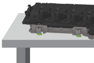
**8** Remova o limpador do cabeçote de impressão e limpe as lentes do cabeçote de impressão.
