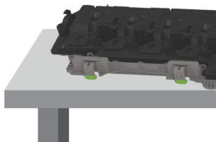
**4** Remova o limpador do cabeçote de impressão e limpe as lentes do cabeçote de impressão.
