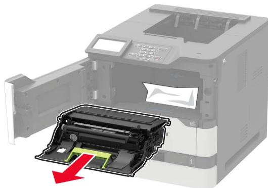
**Upozorenje—potencijalno oštećenje:** Ne izlažite ispisnu jedinicu izravnom svjetlu na duže od 10 minuta. Duže izlaganje svjetlu može uzrokovati probleme s kvalitetom ispisa.
