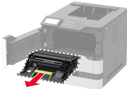
**4** Извлеките блок копи-картриджа из упаковки, а затем потрясите его, чтобы распределить внутри тонер.
