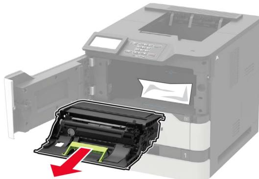
**警告—可能的损坏：**不要让成像部件暴露在直射光线下超过 10 分钟。长时间暴露在光线下可能导致打印质量问题。
