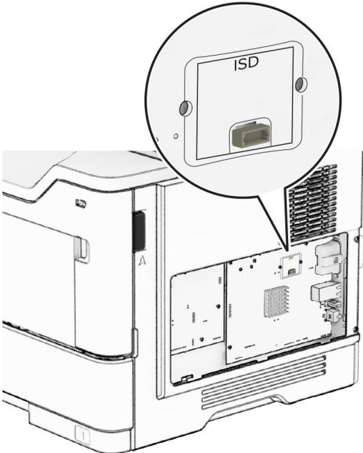
7 Insérez l'ISD dans le connecteur.
