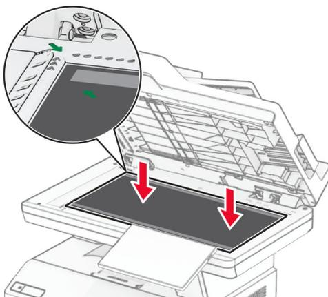
**5** Fermez le capot du scanner pour fixer le nouveau tampon de vitre du scanner.
