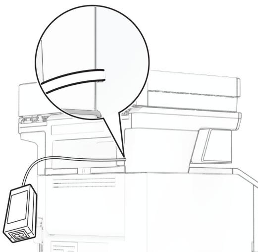
9 Connectez une extrémité du câble d'alimentation de l'agrafeuse au bloc d'alimentation, puis branchez l'autre extrémité sur la prise de courant.
