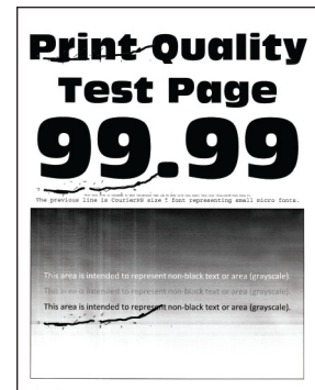
“Повторяющиеся дефекты” на стр. 259
