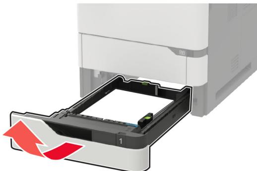
**Attenzione - Possibili danni:** un sensore all'interno del vassoio opzionale viene facilmente danneggiato dall'elettricità statica. Prima di rimuovere la carta inceppata nel vassoio, toccare una superficie metallica.
