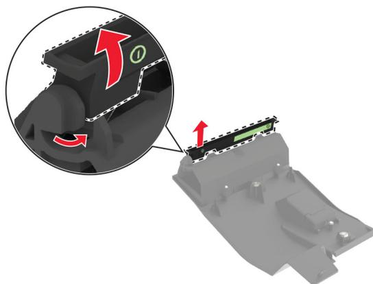
**4** Inserire il nuovo dispositivo di pulizia del fusore rullo caldo.
