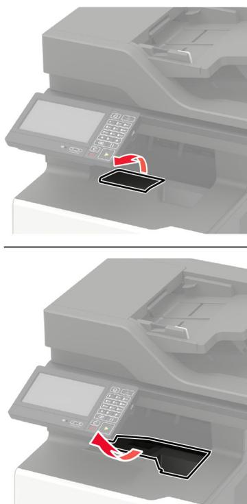
**3** Rimuovere il dispositivo di pulizia del fusore rullo caldo usato.
