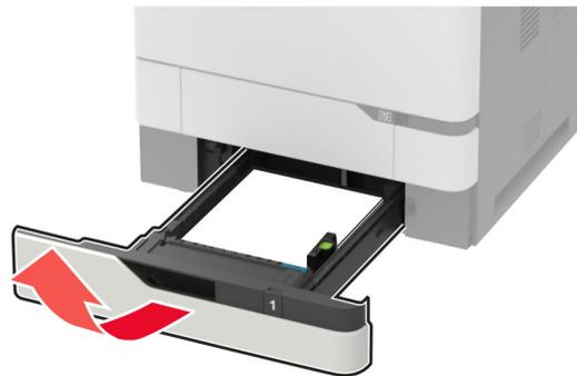
**تحذير—تلف محتمل:** تتعرض أداة الاستشعار المتوفرة داخل الدرج الاختياري للتلف بسهولة بسبب الكهرباء الاستاتيكية. المس سطحاً معدنياً قبل إزالة الورق المنحشر من الدرج.
