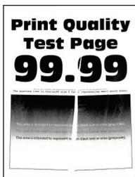
**참고:** 문제를 해결하기 전 인쇄 품질 테스트 페이지를 인쇄해 보십시오. 제어판에서 **설정 > 문제 해결 > 인쇄 품질 테스트 페이지**로 이동합니다. 터치 스크린 프린터 모델이 아닌 경우 (✓) 을 눌러서 설정을 탐색합니다.
