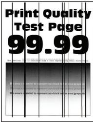
**참고:** 문제를 해결하기 전에 인쇄 품질 테스트 페이지를 인쇄해 보십시오. 제어판에서 **설정 > 문제 해결 > 인쇄 품질 테스트 페이지**로 이동합니다. 터치 스크린 프린터 모델이 아닌 경우 (✓)을 눌러서 설정을 탐색합니다.
