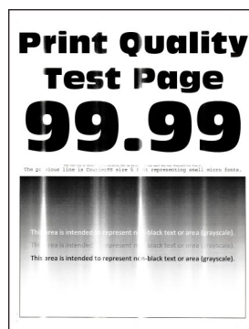
“Vertikala ljusa band” på sidan 344
