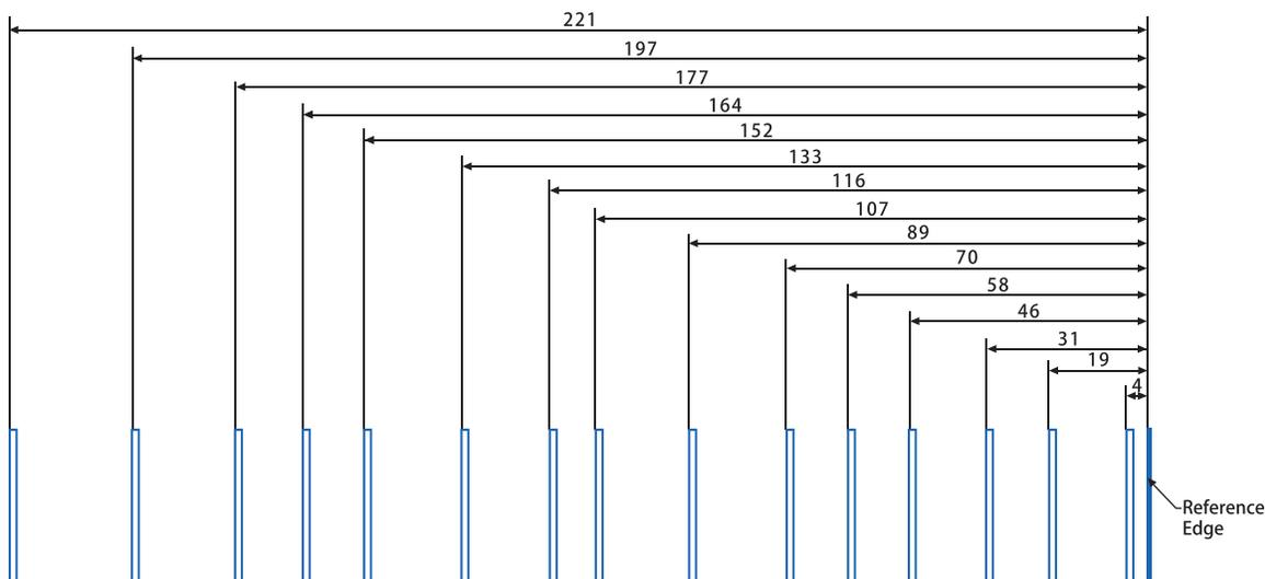
**Lexmark C4150、C4342、C4352、CS720、CS725、CS727、CS728、CS730、CS735、CX725、CX727、CX730、CX735、XC4140、XC4150、XC4342、XC4352 のリブパターン**
