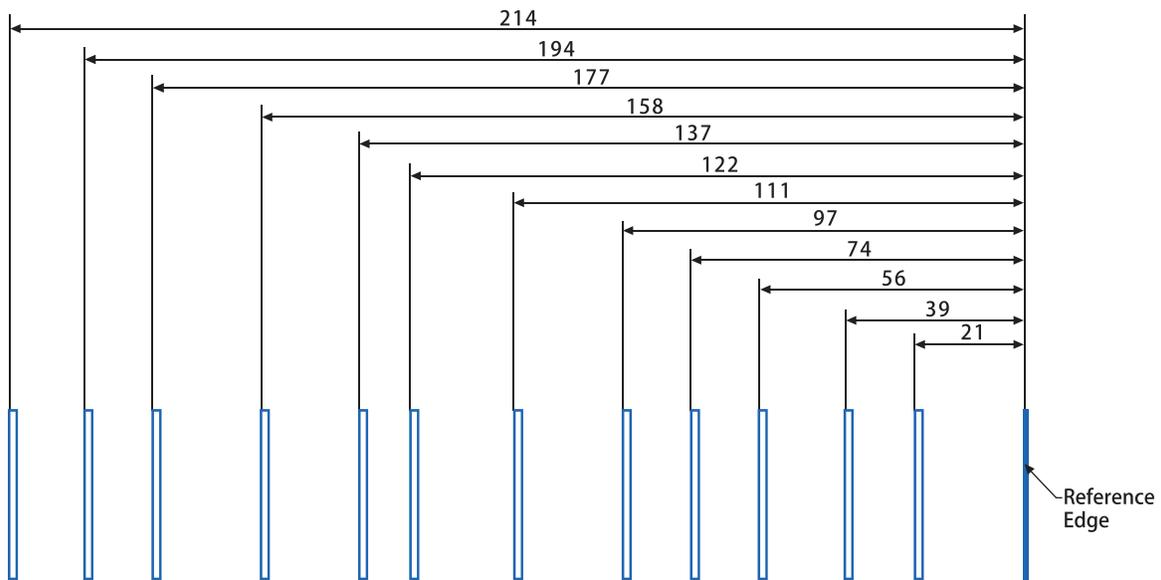
**Lexmark B2865、M5255、M5265、M5270、MB2770、MS725、MS821、MS822、MS823、MS824、MS825、MS826、MX721、MX722、MX725、MX822、MX824、MX826、XM5365、XM5370、XM7355、XM7365、XM7370 のリブパターン**
