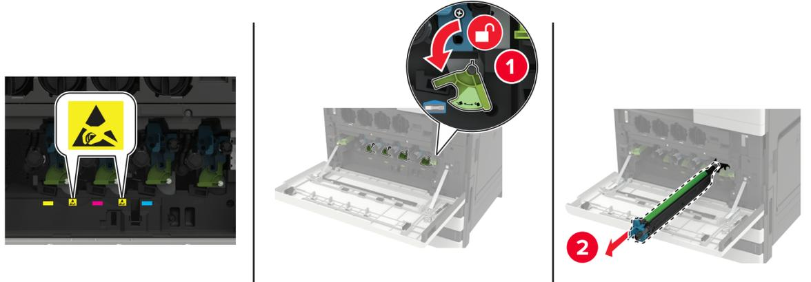
Extraiga la unidad de fotoconductor. Saque la nueva unidad de fotoconductor del embalaje.
