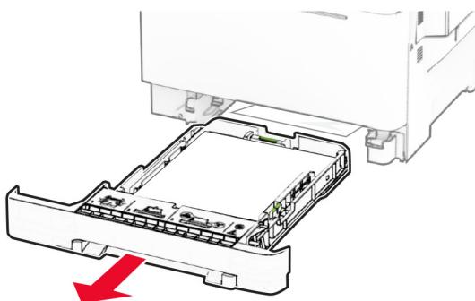
**Upozorenje – potencijalno oštećenje:** Senzor unutar opcione fioke može lako da se ošteći statickim elektricitetom. Dodirnite metalnu površinu pre uklanjanja zaglavljenog papira u fioci.
