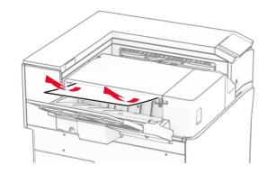
**2** Sujete la palanca F y, a continuación, deslice el finalizador con grapado hacia la izquierda.
