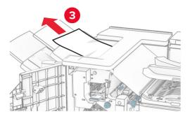
**12** Levante la palanca R4, gire el mando R2 en el sentido de las agujas del reloj y, a continuación, retire el papel atascado.
