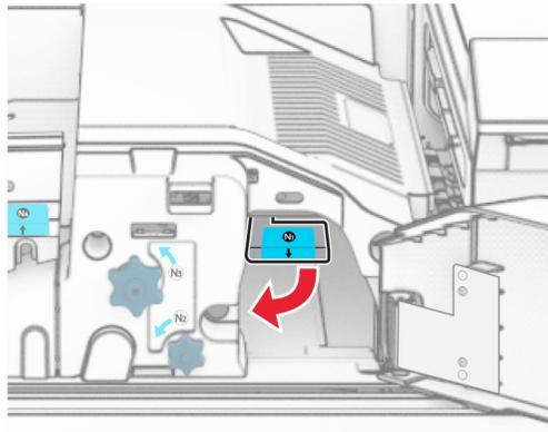
15 Okrenite gumb N2 u smjeru suprotnom od kazaljke na satu.
