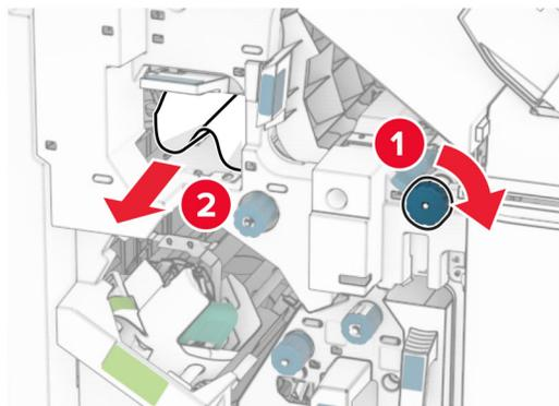
11 Pomaknite ručicu R1 ulijevo, okrenite gumb R2 u smjeru suprotnom od kazaljke na satu, a zatim uklonite zaglavljenu papir između vratašca N4 i N5.
