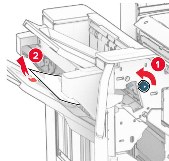
10 Okrenite gumb R2 u smjeru suprotnom od kazaljke na satu, a zatim uklonite zaglavljenu papir između vratašca N4 i N5.
