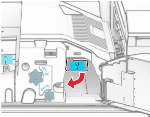
16 Okrenite gumb N2 u smjeru suprotnom od kazaljke na satu.
