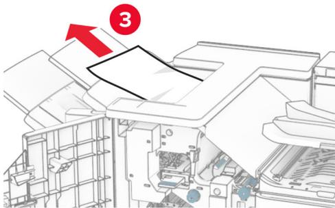
12 Podignite ručicu R4, okrenite gumb R2 u smjeru kazaljke na satu, a zatim uklonite zaglavljenu papir.
