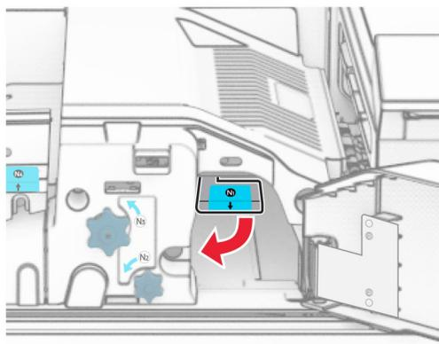
8 Okrenite gumb N2 u smjeru suprotnom od kazaljke na satu.
