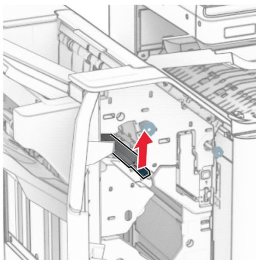
9 Okrenite ručicu R3 u smjeru suprotnom od kazaljke na satu, a zatim uklonite zaglavljenu papir u ladic 1.
