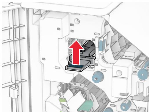
10 Okrenite ručicu R2 u smjeru kazaljke na satu, a zatim uklonite zaglavljenu papir u ručici R4.
