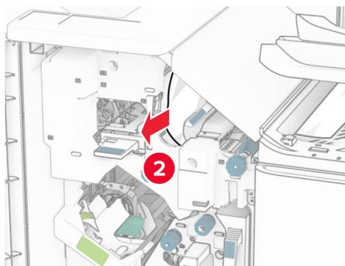
10 Pomaknite ručicu R1 ulijevo, okrenite gumb R2 u smjeru suprotnom od kazaljke na satu, a zatim uklonite zaglavljene papir.
