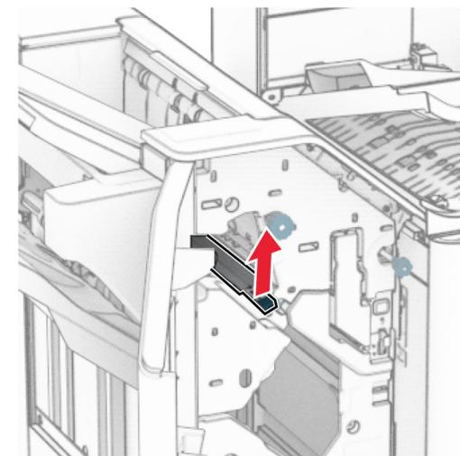
11 Okrenite ručicu R3 u smjeru suprotnom od kazaljke na satu, a zatim uklonite zaglavljeni papir u ladici 1.
