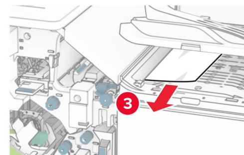
11 Okrenite gumb R5 u smjeru suprotnom od kazaljke na satu, a zatim uklonite zaglavljene papir iz standardne ladice sklopa za završnu obradu.
