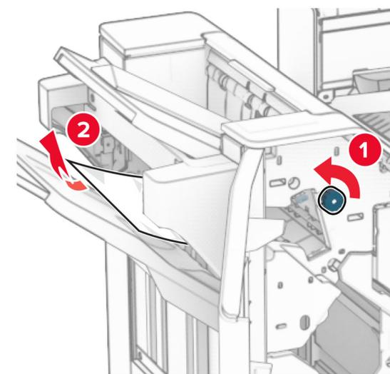
12 逆时针转动旋钮 R2，然后从输纸器盖板 F 中取出被卡的纸张。
