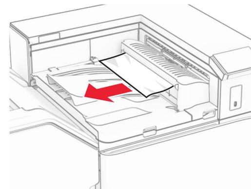
4 打开输纸器盖板 G，然后取出被卡的纸张。
