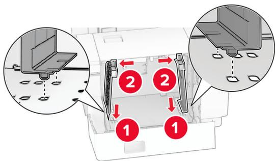
4 将螺钉安装在进纸导轨上。
