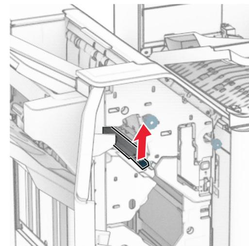
11 逆时针转动旋钮 R3，然后从接纸架 1 中取出被卡的纸张。
