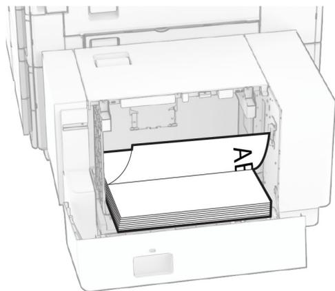
对于双面打印，加载信签时，使打印面朝上，并且页眉朝着打印机的后部。
