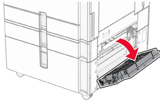
2 Entfernen Sie das gestaute Papier in Klappe E.
