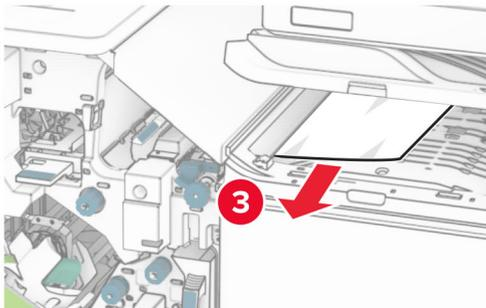
**11** Drehen Sie Knopf R5 gegen den Uhrzeigersinn und entfernen Sie dann das gestaute Papier aus der Finisher-Standardablage.
