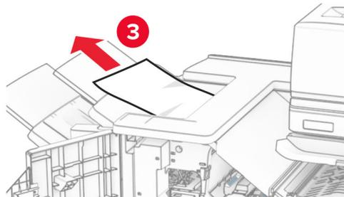
**12** Heben Sie den Griff R4 an, drehen Sie den Knopf R2 im Uhrzeigersinn und entfernen Sie dann das gestaute Papier.
