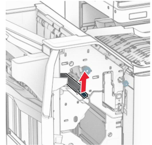
11 Drehen Sie den Knopf R3 gegen den Uhrzeigersinn und entfernen Sie dann das gestaute Papier in Ablage 1.
