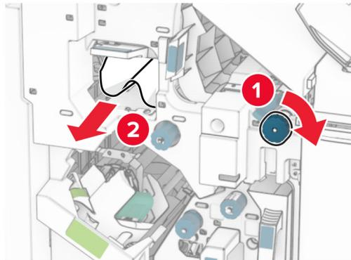
11 Bewegen Sie Griff R1 nach links, drehen Sie den Knopf R2 gegen den Uhrzeigersinn und entfernen Sie dann das gestaute Papier zwischen den Klappen N4 und N5.
