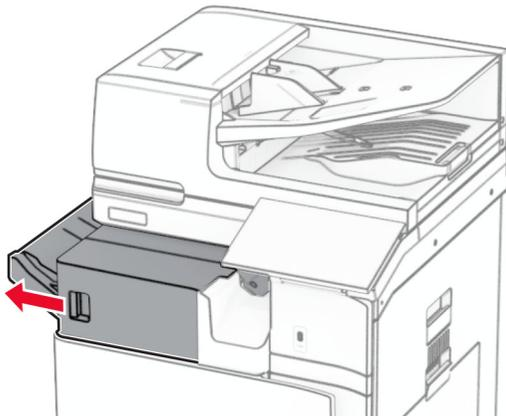
3 Öffnen Sie Klappe R1 und drehen Sie dann den Knopf R2 im Uhrzeigersinn.
