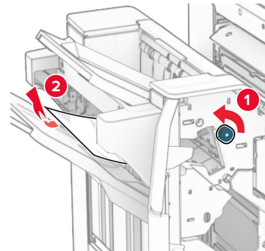
10 Drehen Sie den Knopf R2 gegen den Uhrzeigersinn und entfernen Sie dann das gestaute Papier zwischen den Klappen N4 und N5.
