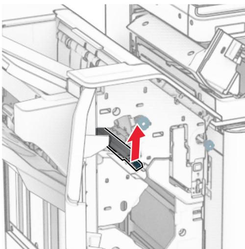
9 Drehen Sie den Knopf R3 gegen den Uhrzeigersinn und entfernen Sie dann das gestaute Papier in Ablage 1.
