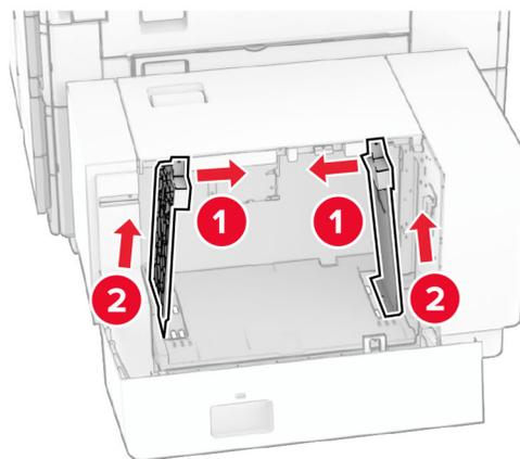
3 调整进纸导轨，使其与加载的纸张尺寸匹配。
