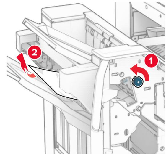
12 逆时针转动旋钮 R2，然后从输纸器盖板 F 中取出被卡的纸张。
