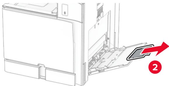
2 调整侧导片以匹配加载的纸张尺寸。
