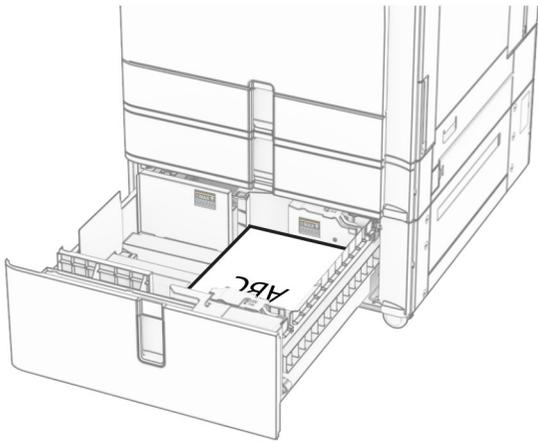
对于双面打印，加载信签时，使打印面朝下，并且页眉朝着进纸匣的前部。
