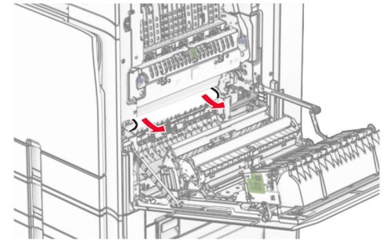
• 在标准接纸架出口辊下方
