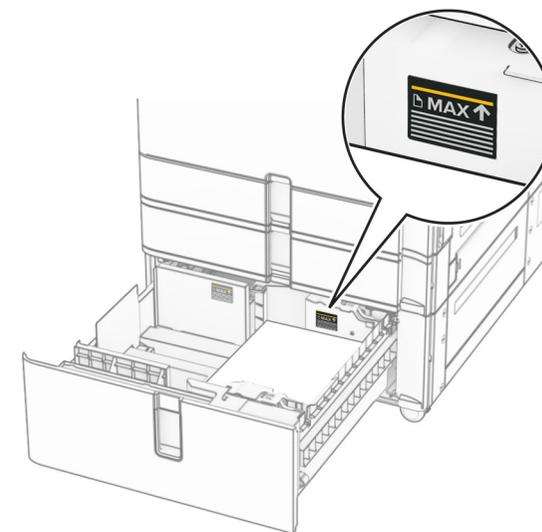
4 将右进纸匣托盘插入打印机中。
