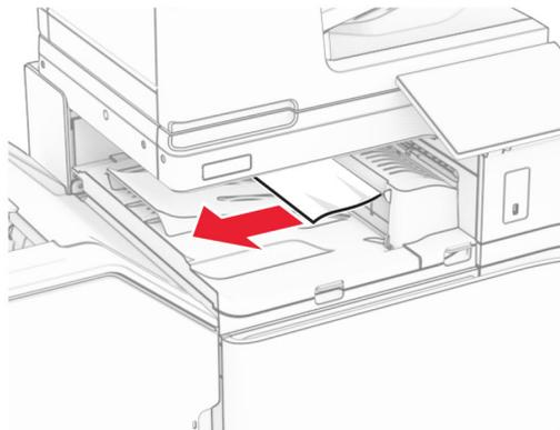
5 打开输纸器盖板 G，然后取出被卡的纸张。
