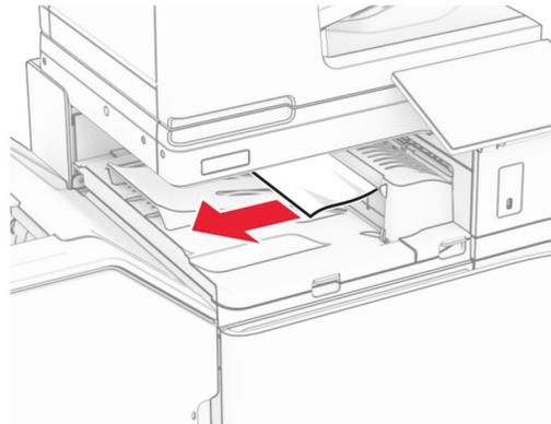
4 打开输纸器盖板 G，然后取出被卡的纸张。
