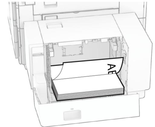
对于双面打印，加载信签时，使打印面朝上，并且页眉朝着打印机的后部。
