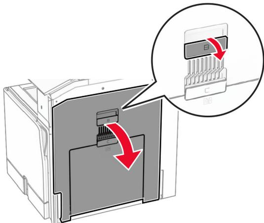
12 从标准接纸架出口辊中取出被卡的纸张。
