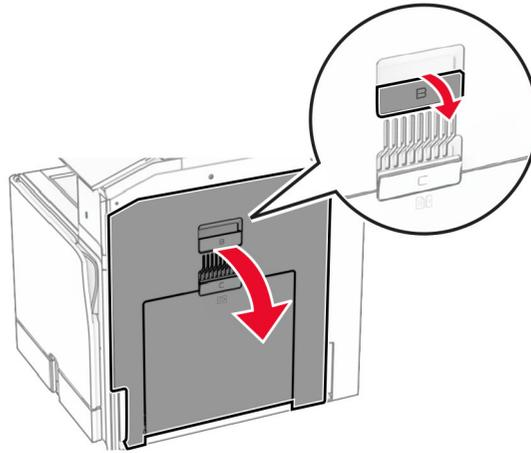
13 从标准接纸架出口辊中取出被卡的纸张。
