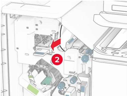
**10** 将手柄 R1 向左移动，逆时针转动旋钮 R2，然后取出被卡的纸张。
