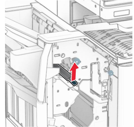
11 逆时针转动旋钮 R3，然后从接纸架 1 中取出被卡的纸张。
