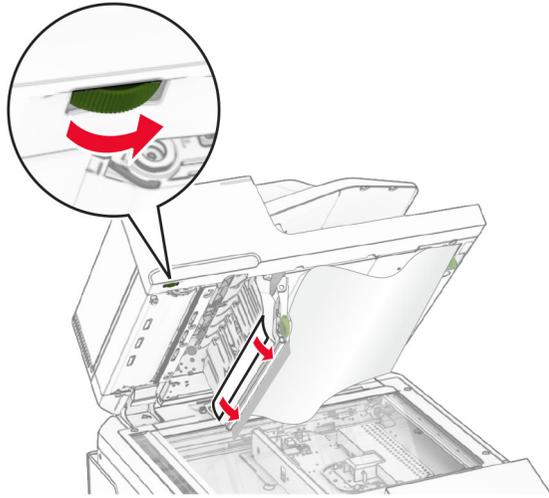
4 关闭盖门 A1，然后关闭扫描仪盖板。
