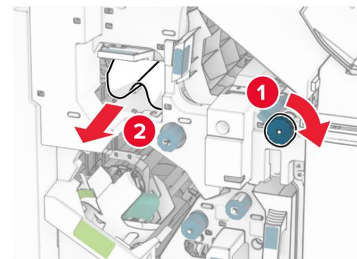
11 将手柄 R1 向左移动，逆时针转动旋钮 R2，然后从盖门 N4 和 N5 之间取出被卡的纸张。
