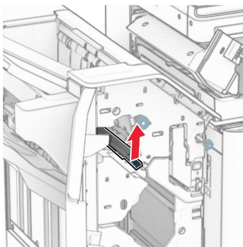
9 逆时针转动旋钮 R3，然后从接纸架 1 中取出被卡的纸张。
