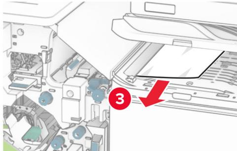
**11** 逆时针转动旋钮 R5，然后从装订器标准接纸架中取出被卡的纸张。
