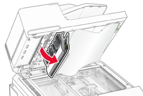
3 将盖门 A1 附近的绿色旋钮向右转动，然后取出被卡的纸张。
