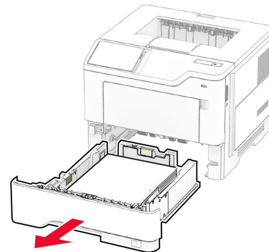
2 Ajuste las guías para que coincidan con el tamaño del papel que va a cargar.
