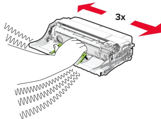
**Upozorenje – potencijalno oštećenje:** Jedinicu za izradu slika nemojte da izlažete direktnom svetlu duže od 10 minuta. Produženo izlaganje svetlu može da uzrokuje probleme sa kvalitetom štampe.
