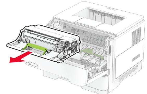
**Upozorenje – potencijalno oštećenje:** Jedinicu za izradu slika nemojte da izlažete direktnom svjetlu duže od 10 minuta. Produženo izlaganje svjetlu može da uzrokuje probleme sa kvalitetom štampe.
