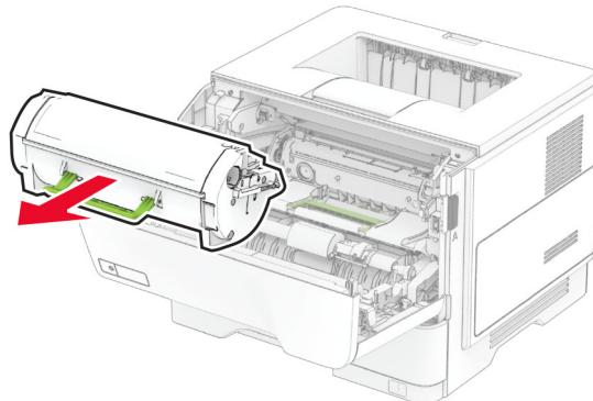
3 Uklonite iskorišćenu jedinicu za izradu slika.
