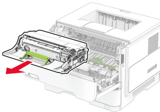
**Cảnh báo—Nguy cơ hỏng:** Không để hộp quang tiếp xúc trực tiếp với ánh sáng quá 10 phút. Tiếp xúc lâu với ánh sáng có thể gây ra sự cố chất lượng in.
