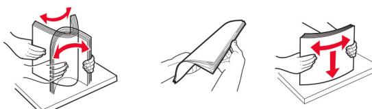
**4 Nạp chồng giấy với mặt để in úp xuống, sau đó đảm bảo rằng các thanh dẫn vừa khít với giấy.**
