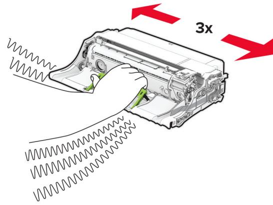
**Cảnh báo—Nguy cơ hỏng:** Không để hộp quang tiếp xúc trực tiếp với ánh sáng quá 10 phút. Tiếp xúc lâu với ánh sáng có thể gây ra sự cố chất lượng in.
