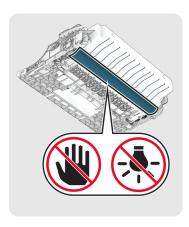
6 Setzen Sie die neue Belichtungseinheit ein.
