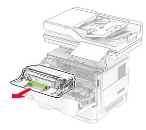
Warnung—Mögliche Schäden: Setzen Sie die Belichtungseinheit nicht länger als zehn Minuten direktem Licht aus. Wenn es zu lange dem Licht ausgesetzt ist, kann dies zu Problemen mit der Druckqualität führen.
