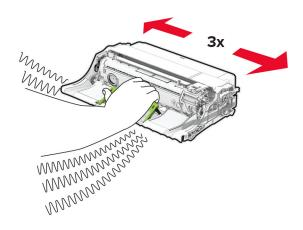
**Warnung—Mögliche Schäden:** Setzen Sie die Belichtungseinheit nicht länger als zehn Minuten direktem Licht aus. Wenn es zu lange dem Licht ausgesetzt ist, kann dies zu Problemen mit der Druckqualität führen.
